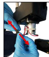
⑤… 新しいギヤポンプを交換し、逆の手順で組み立てて下さい。
