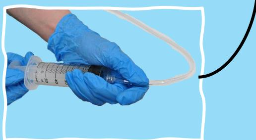
ポンプスイッチを OFF にした状態でドリル側の逆止弁付継手から 給水ホース を外して 注射器を差し込み、水を吸い上げて下さい。
