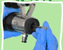
グリップパイプの隙間に スパナ を差してシャンクの回転を固定し、ダイヤチップ(ビット)をプライヤーで 反時計方向 に回して外してください。
