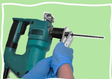
シャンクと注水ボディにスパナをかけて、シャンクをダイヤチップ(ビット)側から見て反時計方向に回して外してください。
