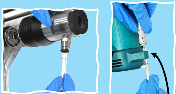
給水ホース、排水ホースを循環部とドリルの継ぎ手に差し込み、ドリルコードを循環部へ接続してください。
