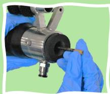
グリップパイプの隙間に スパナ を差してシャンクの回転を固定し、ダイヤモンドチップ(ビット)をプライヤーで 反時計方向 に回して外してください。
