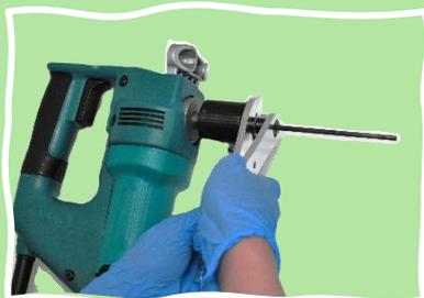
シャンクと注水ボディにスパナをかけて、シャンクをダイヤモンドチップ(ビット)側から見て反時計方向に回して外してください。
