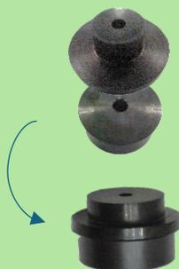
グリップパイプを外し、ブッシュ固定ネジを六角レンチで緩めた状態で、ブッシュ外しパイプを使い、内側からブッシュ を押してください。
