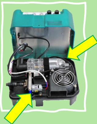
循環部のトップカバーを取り外し、側面ネジを取り外してアンダーケースを開きます。断線に注意して配線を付け替えてください。取説をよく読み交換してください。
