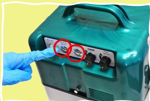
1. 穴あけ作業が終了したら、タンクの水をきれいな水に交換して、グリップパイプ先端のゴムパットを壁か当て板に当て、ドリルの電源をOFFのままポンプとバキュームのスイッチを入れ、ホース内、センターパイプ内の循環清掃を15~20秒程度おこなってください。
