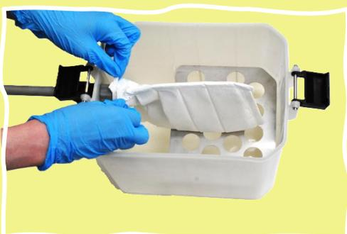
2. 使用済みのろ過フィルターと循環水を廃棄しタンク内を空拭きしてください。水分が残った状態で保管すると電気系統故障の原因になります。
