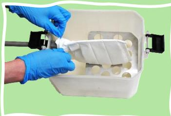
循環装置のトップケースを取り外し、センターパイプの固定を緩めてセンターパイプをある程度引き抜いて下さい。その後フィルターのマジックテープを剥がし、循環水を汚さないように取り外してください。
