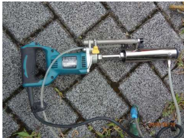
写真 6. 3 作業に使用した水循環式無振動ドリル（商品名：水すまし ATⅢ型）
