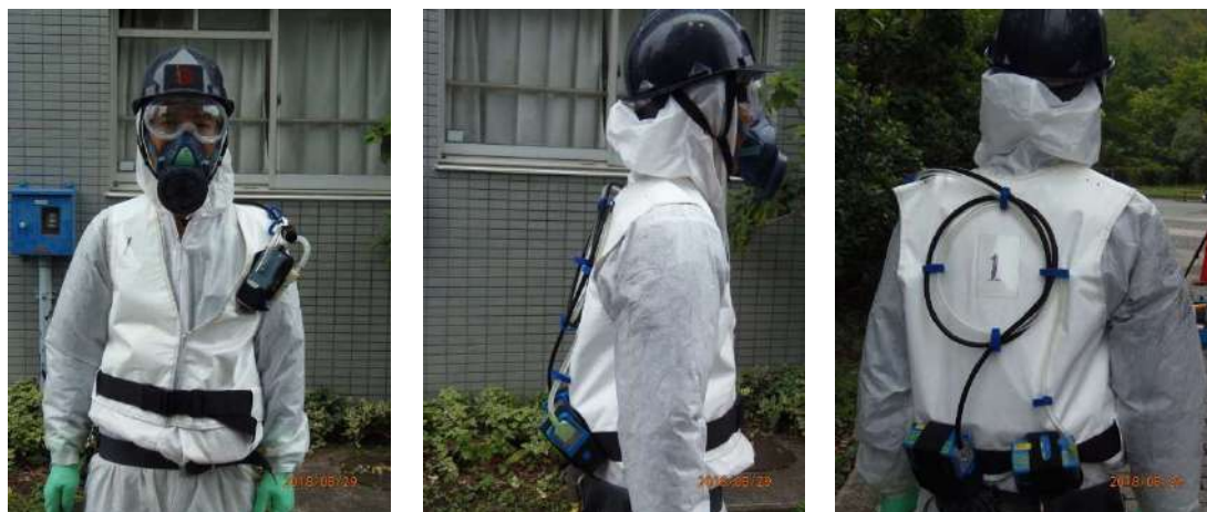
写真6. 6 個人ばく露濃度測定に係る機器の装着状況
