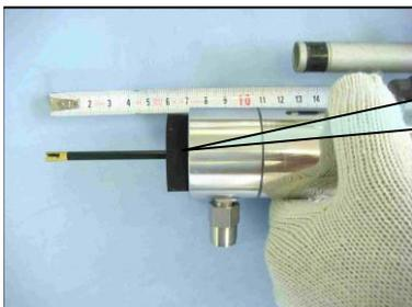
軸のクリップバンドで穿孔深さを設定して下さい。
