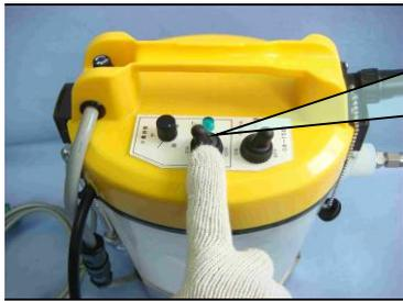
作業前にポンプスイッチを入れダイヤ刃先から水が十分出るか確認して作業を開始してください。
