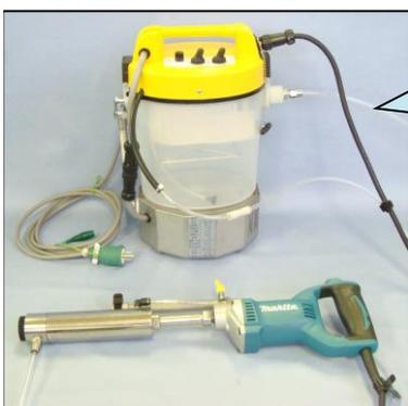
ドリルと循環装置をつないでいるホースが循環装置より大きくたれた状態での穿孔は避けてください。
